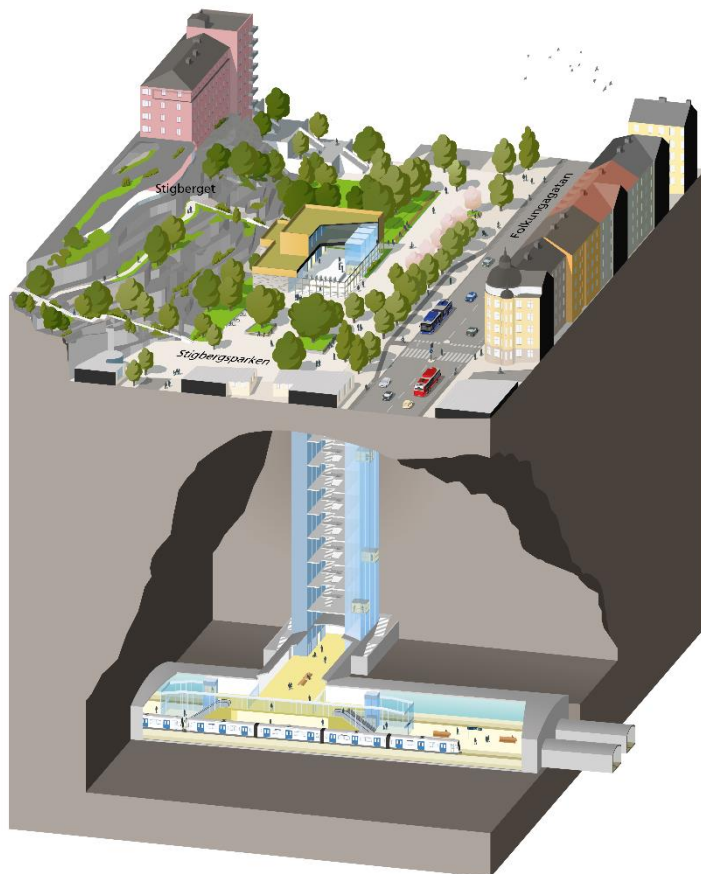
Querschnitt der künftigen U-Bahn-Station Sofia mit dem darüberliegenden Stigbergspark (Bild: Region Stockholm / Sweco)
