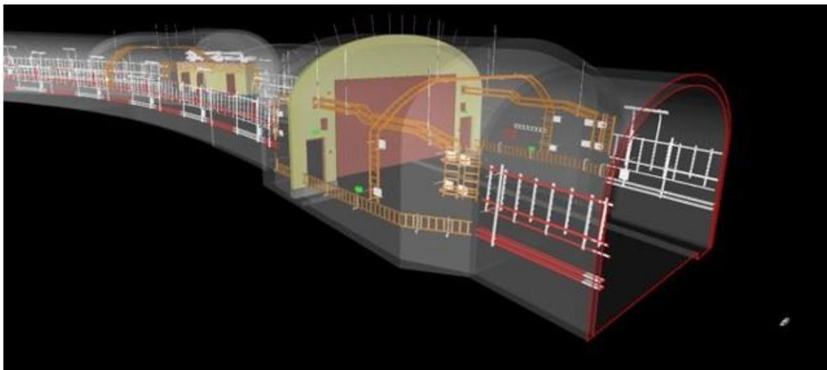
Visualisation du modèle BIM du tunnel de raccordement pour le métro de Stockholm (image : ©Implenia).
