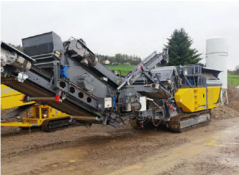
Grâce à l'utilisation d'une machine recyclant le gravier, l'ancien fondement peut être retraité, ce qui permet d'économiser du gravier neuf.
